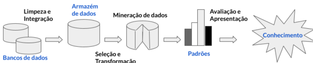
Figura 1 - Mineração de dados como parte integrante do processo de descoberta do conhecimento.
